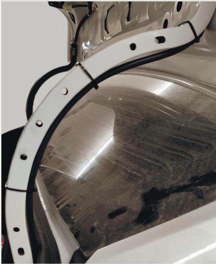
**7** Соедините тройник с омывателем камеры шлангом, закрепите его стяжками на штатной проводке. Обратный клапан устанавливается как можно ближе к форсунке омывателя (направление потока жидкости указано на клапане стрелкой).
