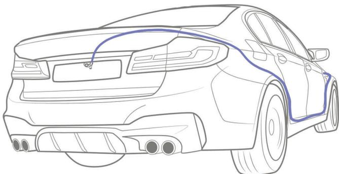
**8** Включите омыватель лобового стекла, убедитесь в отсутствии течей. Сборка авто осуществляется в обратной последовательности (при сборке убедитесь, что устанавливаемые накладки не пережимают шланг подачи жидкости к омывателю камеры).
