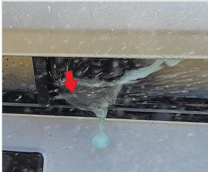
**9** Для регулировки форсунки используйте кнопку - гвоздь (в комплекте), согнув её плоскогубцами, как это показано на рисунке.
