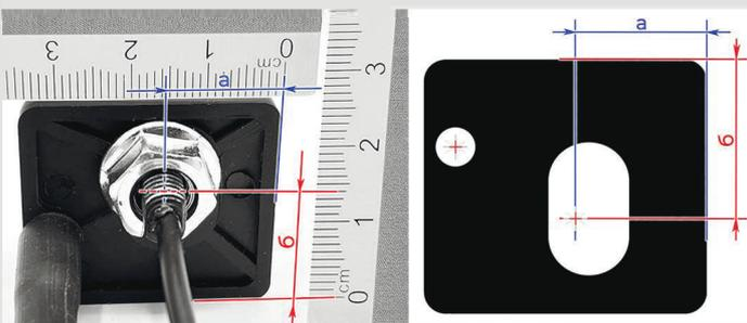
**3** Наклейте шаблон на место предполагаемой установки камеры, затем высверлите отверстие диаметром 5,5 мм под штуцер омывателя камеры и отверстие, на 1 мм превышающее диаметр крепёжного винта камеры.
